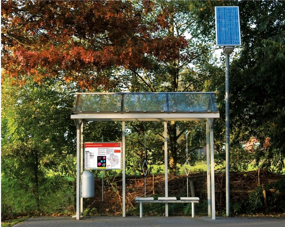
Abbildung 27: Haltestelle mit Solarbeleuchtung
