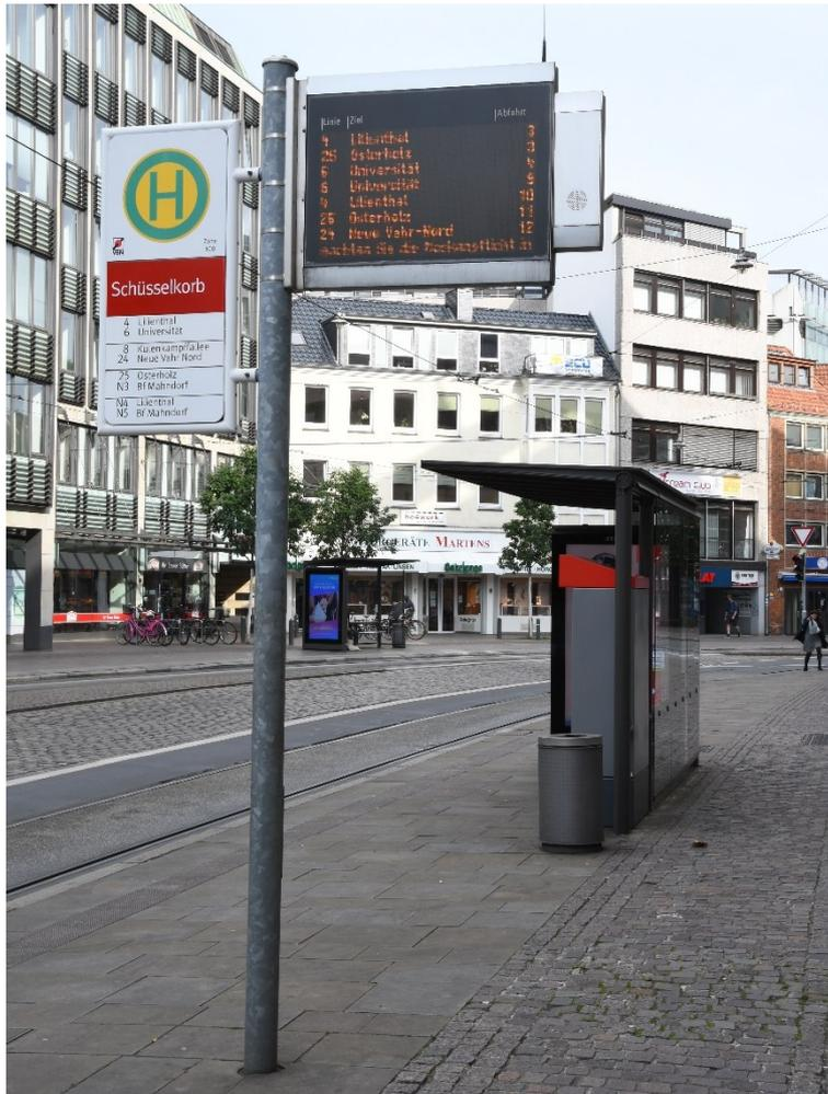
Abbildung 9: Kombimast mit Haltestellenschild und DFI [\(neu\)](#)
