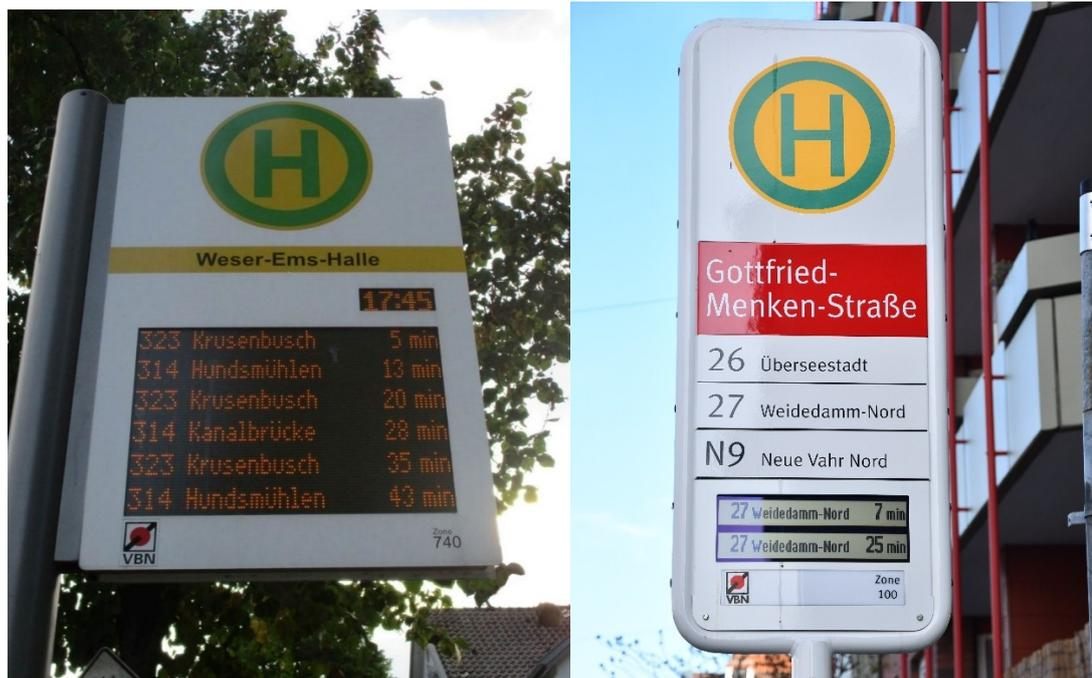
Abbildung 21: Haltestellenschilder mit integrierter dynamischer Fahrgastinformation
