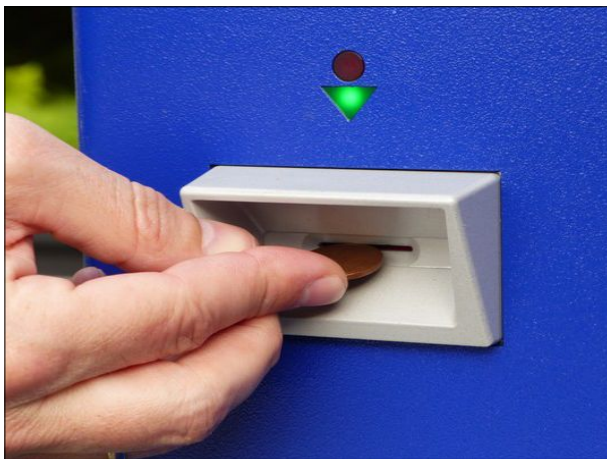
Abb. 38: Dieser neue Entwerner in Oldenbüttel kann nicht mit einer Münze außer Betrieb gesetzt werden, da der Schlitz zu klein ist.
