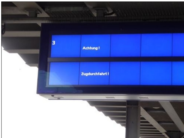
Abb. 23: Zugdurchfahrt und Gleisnummer könnten in Delmenhorst sicher auch größer dargestellt werden. Abgesehen davon war die Steuerung der Fahrgastinformationsanlage gestört.
