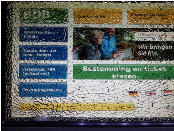
Abb. 38: Der Bildschirm des Fahrkartenautomaten in Etelzen an Gleis 1 war stark beschädigt. Das Gerät funktionierte aber einwandfrei.
