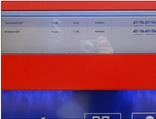
Abb. 55: In den neuen Fahrkartenautomaten der NordWest-Bahn ist ein Bildschirm integriert, der aktuelle Informationen zu den Zugabfahrten anzeigt.
