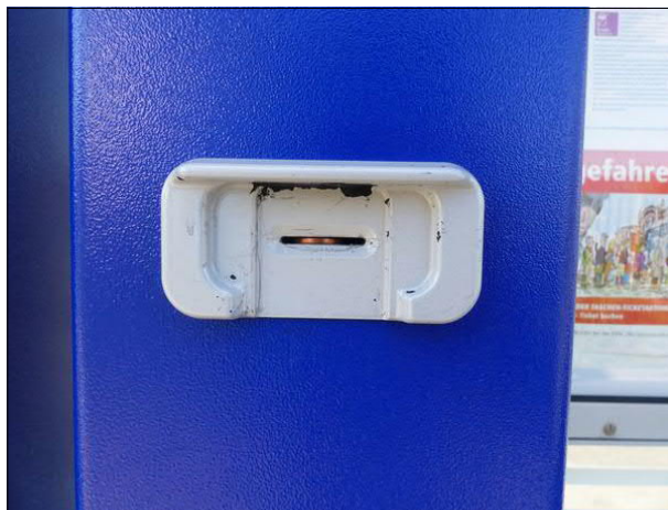
Abbildung 32: In Bremen Mühlenstraße war der Entwerter mit einer Münze verstopft. Dieser neue Entwerter hat einen höheren Schlitz als das Vorgängermodell, so dass Münzen hineinpassen. Zudem ist die Stempeltechnik offenbar sensibler und damit weniger fahrgastfreundlich.
